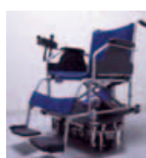
安定化装置付き小型 全方向移動車いす
