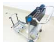
▲パワーアシスト付き空港内手荷物カートロボット
