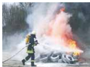
泡消火剤による消火実験
