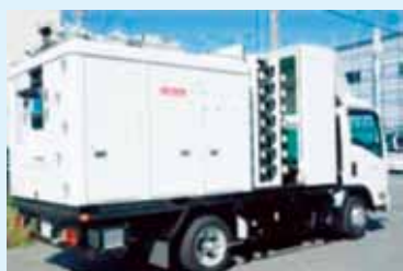
走行型トンネル点検車両MIMM
