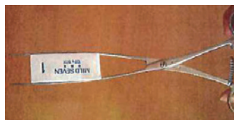
従来の鉗子だと先端は閉じず 先端で同時に物はつかめない
