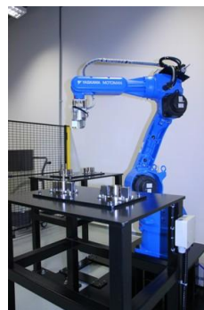
組立ロボット
