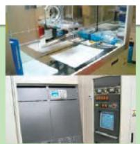
(※1) 中電流型イオン注入装置
