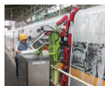
▲車両洗浄ロボット
