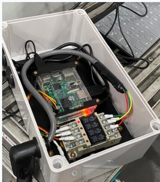
マシニングに実装した PaspberryPI
