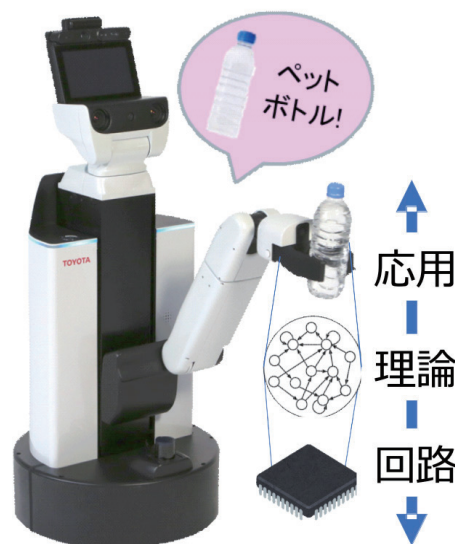
図. リザーバーチップでのロボット物体認識例
