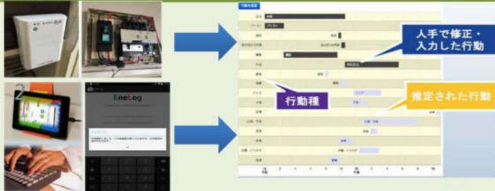
Androidアプリにより習得される照度データ、電力データ、行動データから推測された行動情報をサーバーに保存し、利用者のWebブラウザに可視化・編集できるWebシステム
