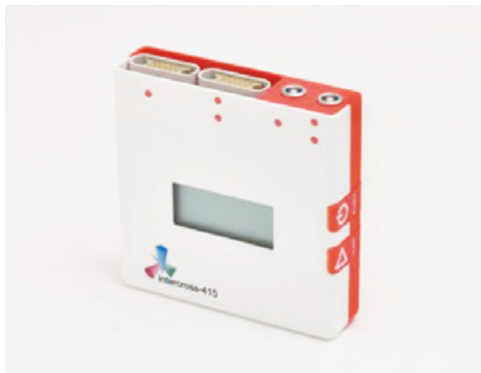
▲ミニチュアDAQターミナル(型式 intercross-415)
