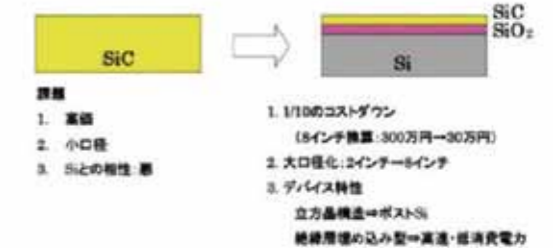
図-3)SiC基板製造技術の比較 従来技術(昇華法) 当研究室開発の新技术
