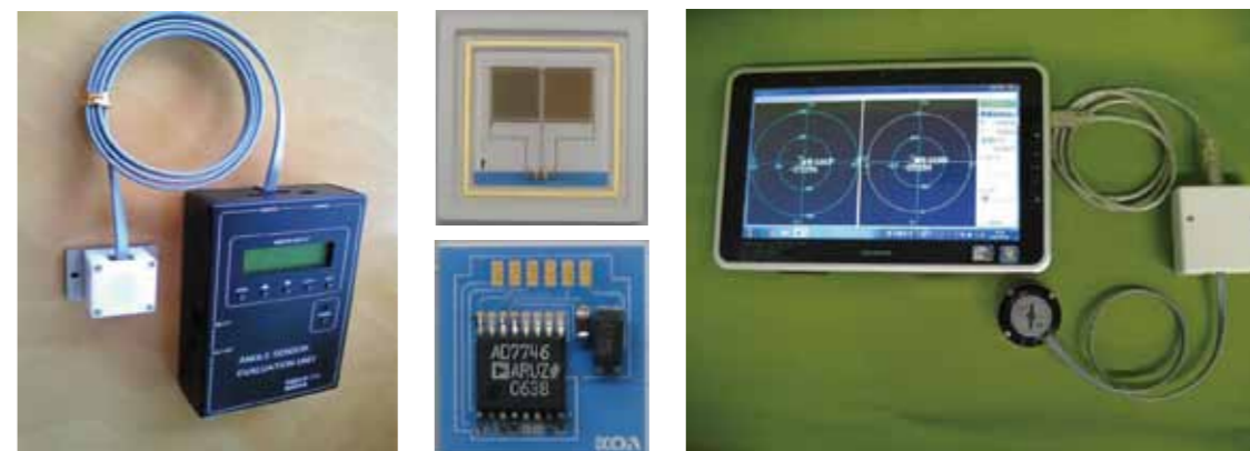
▲1軸水晶MEMS傾斜角センサシステム ▲1軸水晶MEMS傾斜角センサ ▲水晶MEMS傾斜角センサ モニターシステム
