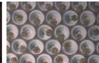
▲孔を拡大した顕微鏡写真 約1,000個の孔中に1個ずつ3次元細胞塊を培養。1個の孔は直径約300μm、細胞塊は直径約150μm。
