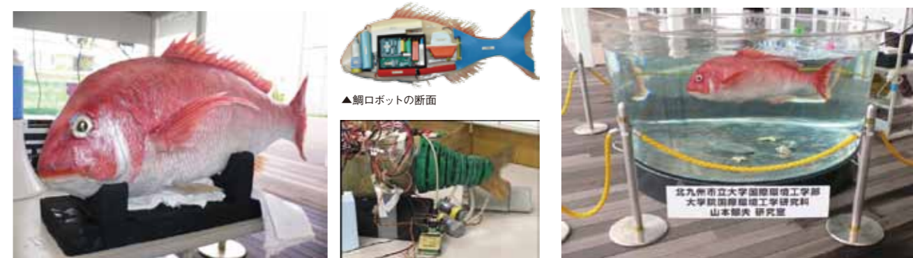
▲鯛ロボット ▲鯛ロボットの断面 ▲弾性振動翼 ▲遊泳中
