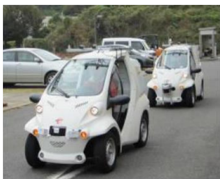
（トヨタ車体制のコムスを改造した自律走行車）
