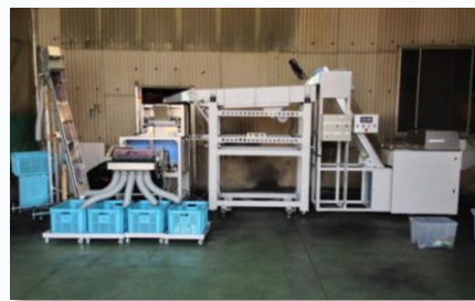
写真2 ペットボトルキャップ選別装置
