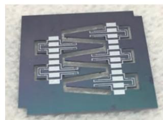
マルチ変位計デバイス試作結果
