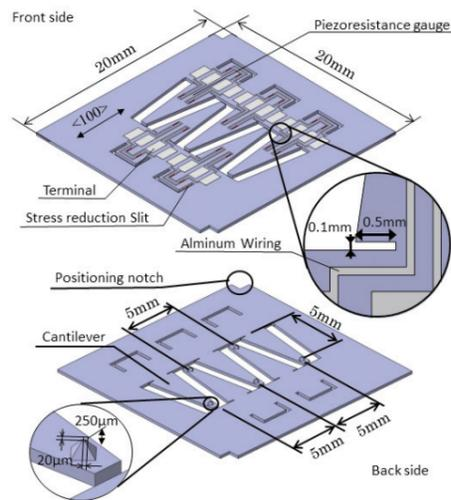
マルチ変位計デバイスの構造
