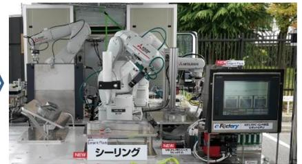
**③ 力覚応用技術(組立・検査)** (搭載機種:RV-7FRL-R/力覚センサ)
