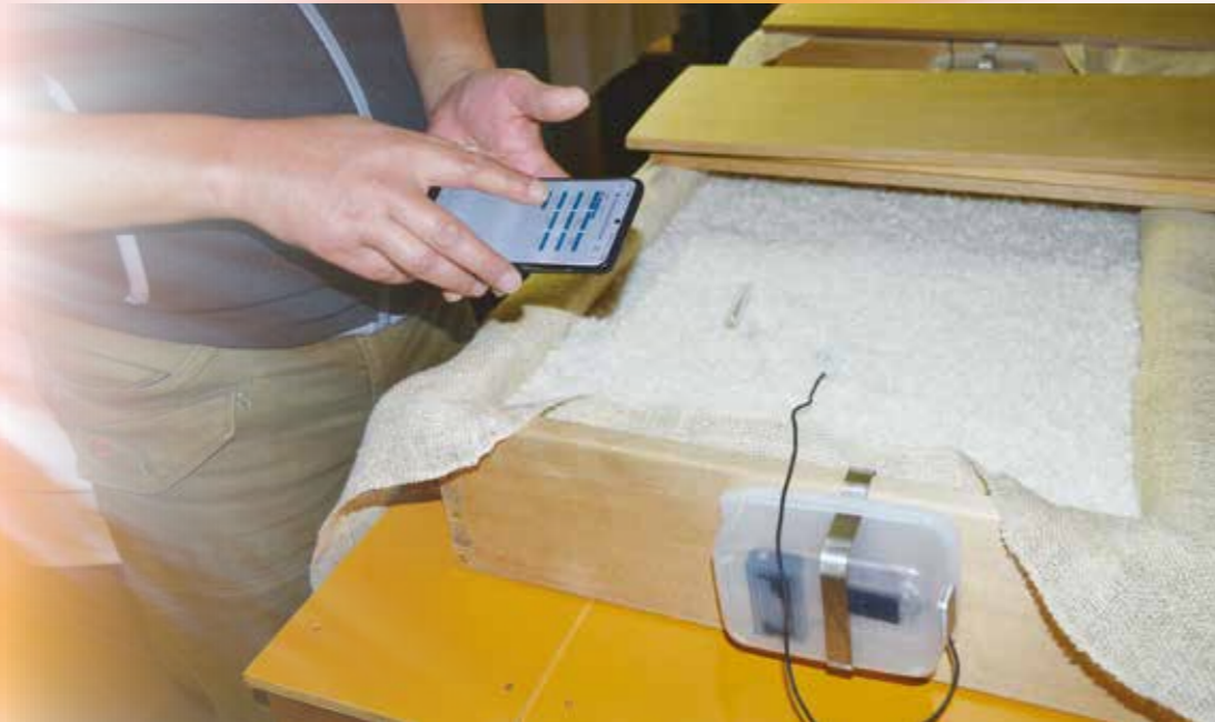
温度データをクラウドシステムに収集・蓄積してスマートフォン上で見える化した
