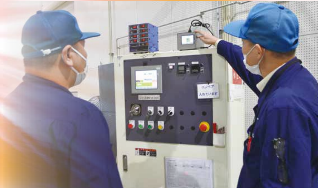
ラズベリーパイを使ってプレス機の稼働状況を監視している
