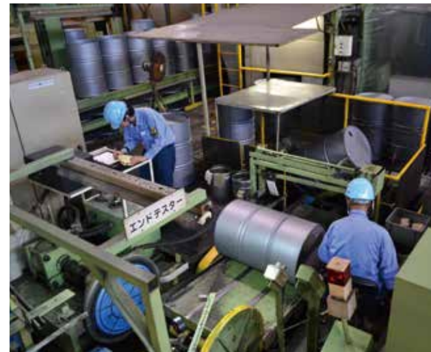
自動化ラインで大量のドラム缶が製造されていく
