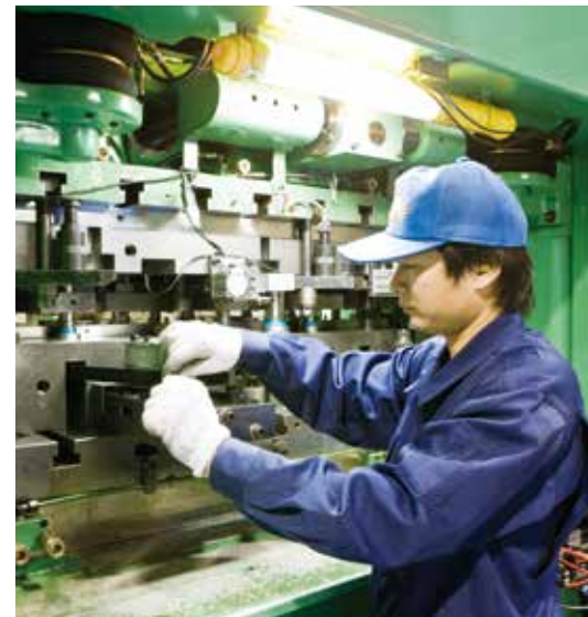
AIやディープラーニングの導入も検討する(製作した金型をプレス機に装着している)
