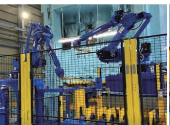
ロボットによる材料投入
