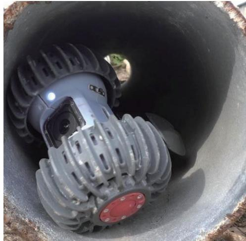
図. 管中の作業ロボット
