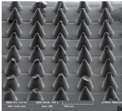
図. ヒドロゲルマイクロニードルセンサー
