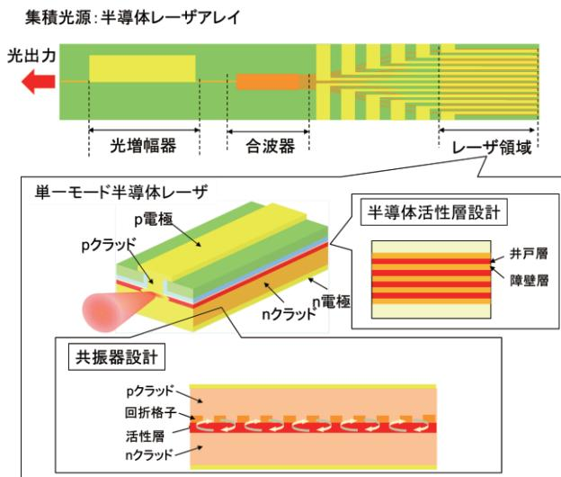
図. 光半導体集積回路の構造設計
