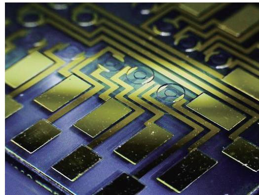
図. バイオセンサー用基板の試作例
