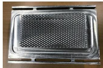
翼型ピンフィンヒートシンク外観
