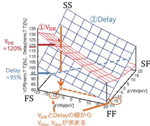
図. フリップフロップの記憶保持特性と RO 周波数・IDDQ などから、ばらつき量( $\Delta V_{th,N}$ ,  $\Delta V_{th,P}$ )を推定する
