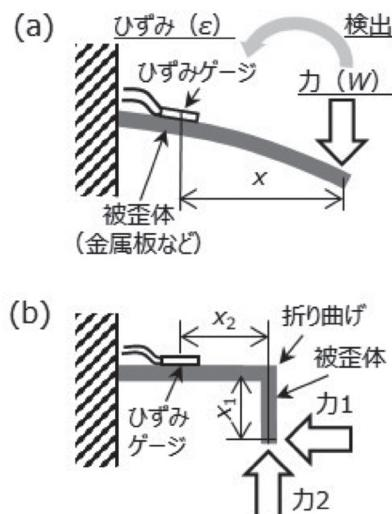
図. センサー変形前後の構造
