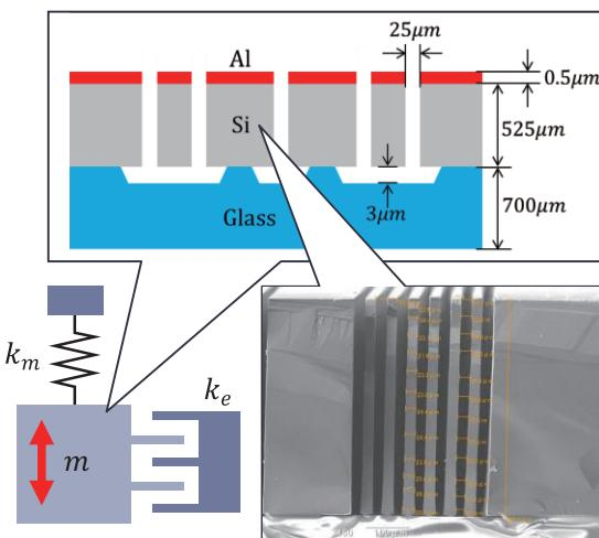
図. MEMS のバネマス系の構造
