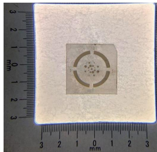
図. ダイヤモンド pin ダイオード
