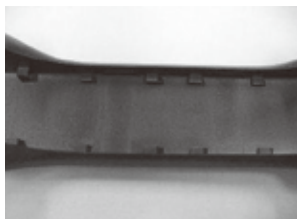
多段化したスライド（4段）で製品の内部のアンダーカットも処理しています。
