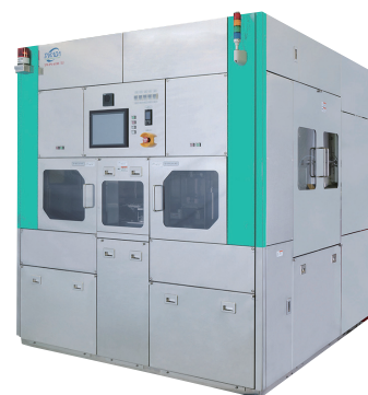
枚葉式ウェット処理装置TWP (量産向け)
