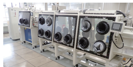
全固体電池試作設備
