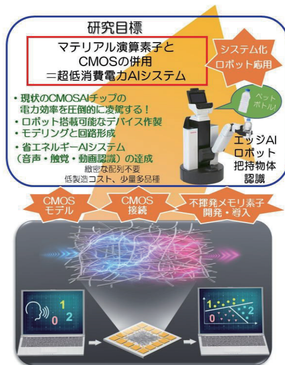
図. ダイナミクスを利用したランダムネットワークリザーバーとその応用
