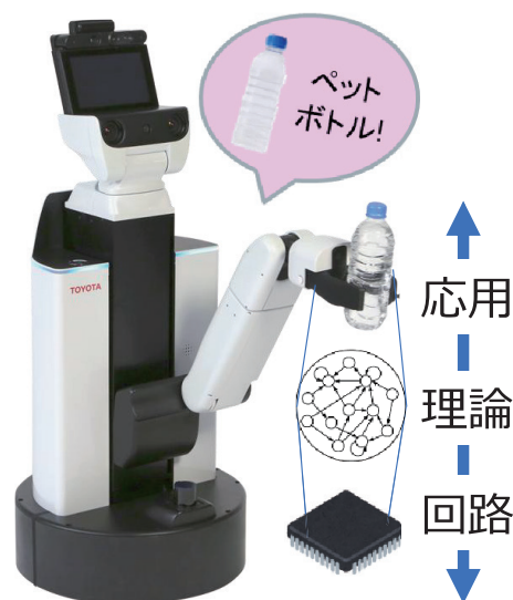
図. リザーバーチップでのロボット物体認識例
