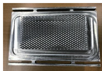
翼型ピンフィンヒートシンク外観
