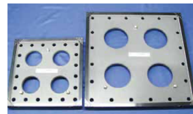
ホールプレート (3次元測定機校正用)
