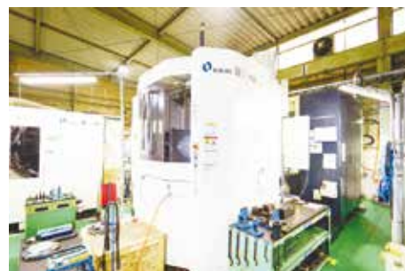
横型マシニングセンター 牧野フライス製 a81nx
