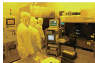
▲開発・試作支援設備:半導体試作設備の例 (フォトリソグラフィ工程)
